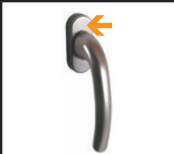
Løft dekkbrikken på vrideren. Drei den 90 grader og skru på vrideren med 2 stk 5x40mm maskinskruer. Vrider peker nedover når vinduet er stengt.
